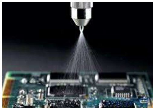
Figura 3.- Aplicación de recubrimiento conformal por método de aerosol sobre PCB's.
