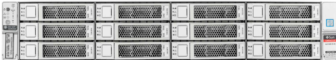
Figura 23.- Vista frontal de los servidores de alta capacidad y XT de Oracle Exadata Storage Server X9M, X8M y X8.
