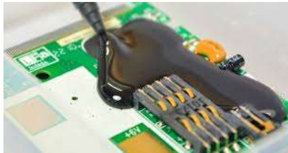
Figura 2.- Proceso de encapsulado de PCB's con resina epóxica.
