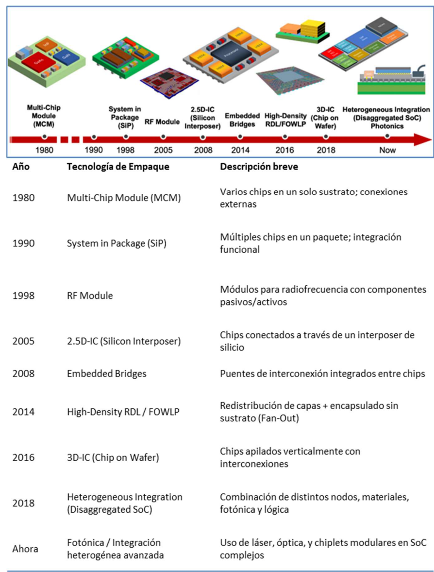
Figura 17 Evolución del proceso de empaquetamiento de chips.
